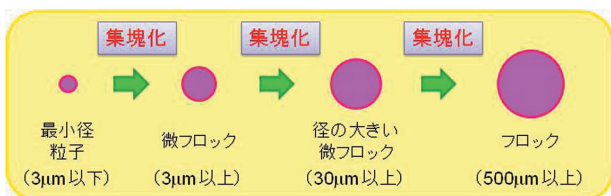
図2 凝集処理の概念図
