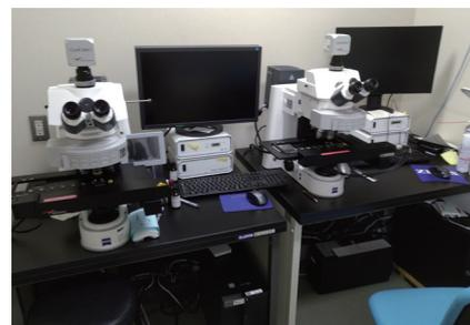
写真4 被ばく事故の線量評価のための染色体分析装置
