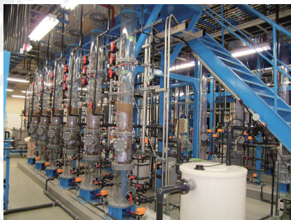
写真1 浄水処理実験プラント
